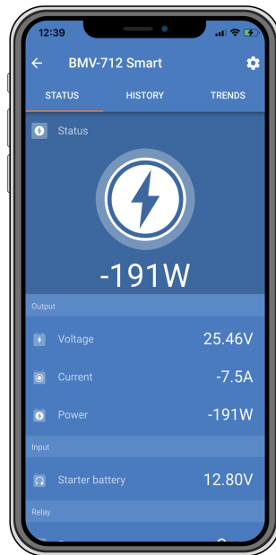
VictronConnect-app-statusschem van een accumonitor die in de DC-bewakingmodus draait.
